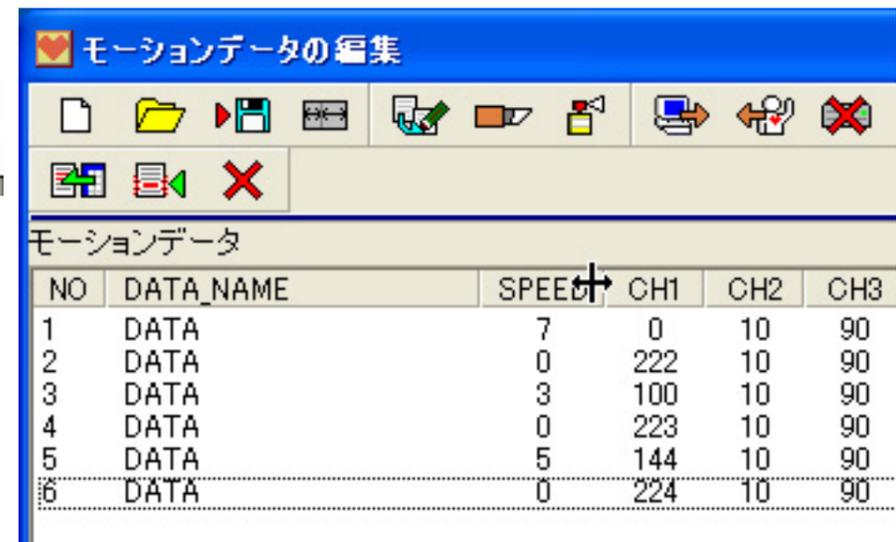
右は、そうやって CH1 のサーボの切り替えを入力した例だ。「モーションデータの編集」で SET1,2,3 は 222,223,224 の数字で表されている。また、この場合のスピードが0に設定されている点に注意しよう。例では、CH1 のサーボは、0、100、144 の順に動いているが、その間に設定が SET1,2,3 と変更されている。
