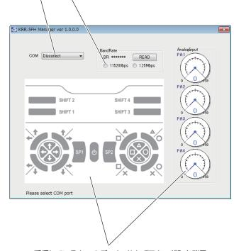
受信しているキーのデータ、およびアナログ入力端子 からのデータが表示されます。
