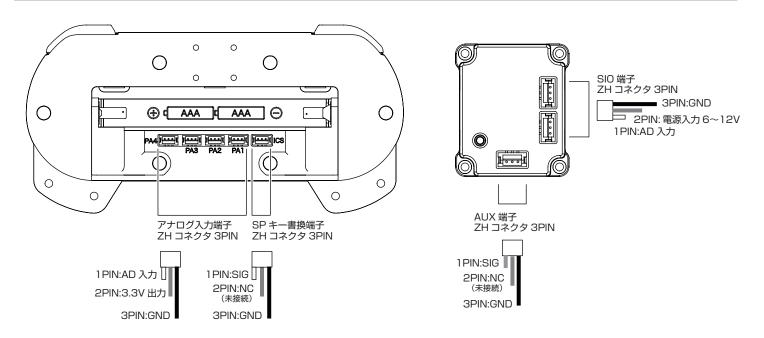
弊社製対応ボードとの接続例です。 ※安全で確実な接続のため、接続して各ボードのマニュアルを良くご確認ください。
