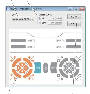
③設定したいキーをクリックします。設定されているとオレンジ色で表示されます。もう一度クリックすると設定が解除されます。
