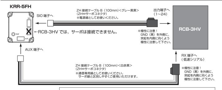
※HTH3 のオプションウィンドウで「KRC-1 から制御する」にチェックを入れてください。 ※電源用 ZH 接続ケーブルB<グレー黒黒> を接続した端子の設定は出力 L に設定してください。
