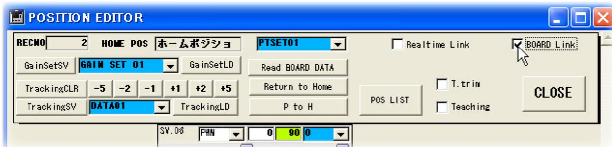
BoardLink をクリックしてチェックを入れると、ポジションエディター上の、各サーボに対応するスライダーを動かすことで、サーボを動作させることができます。
