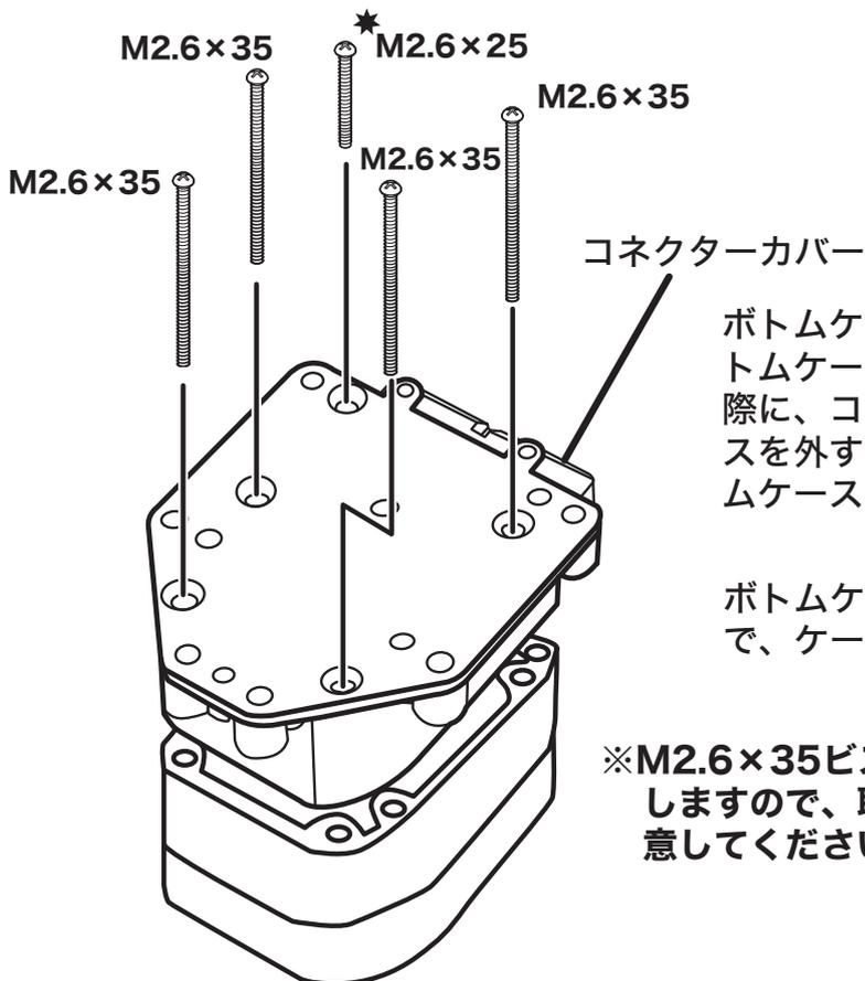
ボトムケースを外した本体にオプションボトムケースを図のように取付けます。その際に、コネクターのカバーは、ボトムケースを外す前と同様に、ミドルケースとボトムケースの間に挟みこんでください。
