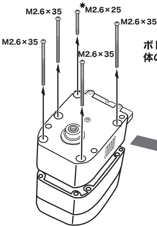
ボトムケース側の5本のビスを外し、本体のボトムケースを取り外します。
