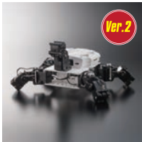
KXR-L4T-R カメ型・ローバー型 Ver.2 アカデミックバック 価格:オープン No.03156 4足歩行のカメ型ロボットのキットです。足先を車輪に交換することでローバー型に換装することができます。Arduino用シールドと搭載用パーツ、PSDセンサが付属するアカデミックバックです。
