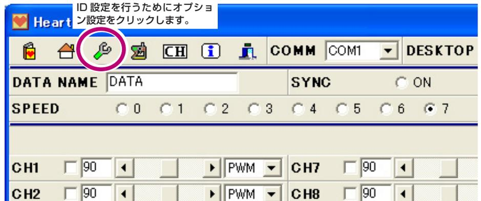
オプション設定ウィンドウでは、通常の 2 枚のボードをリンクした接続時に、ID の取得や設定のボタンは操作しないでください。ID 関連のコマンドは、1 枚のボードのみが接続されている前提で動作しますから 2 枚のボードが接続されている場合、正しく動作しません。特に ID 設定のボタンを押すと、2 枚のボードがおなじ ID に設定されてしまう場合があります。
