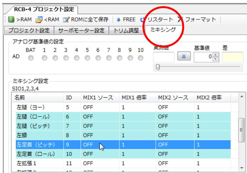
③ ミキシング設定のMIX1で、センサーの接続されているADポートの番号を選択します。今回はAD1(ピッチ軸ジャイロ)を選択します。
