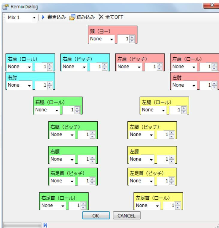
②データを読み込む場所を選択します。対応するサーボをクリックすると青く変化します。この状態が選択されている状態です。
