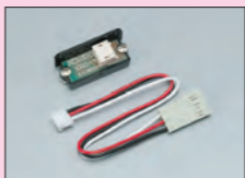
ジャイロセンサー KRG-4 ¥5,250 No.03003 ●軽量省スペース。専用ケース設計により取り付け性良好。新型センサー使用より、環境や長時間により出力が変動するドリフトが、非常に少なく抑えられています。 ●重量:1.4g ●寸法:22.0×9.0×9.0mm ●消費電力:約2mA ●電源電圧:3~5V
