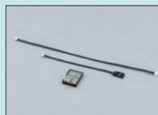
KRI-3 ¥2,625 No.03022 ●KRR-1からの低速シリアルを、RCB-4HVのシリアル端子(高速シリアル)対応に変換するための中継基板。KHR-3HVを無線接続するための必需品です。
