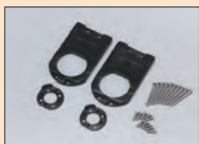
アームサーボター4000A 2個入 ¥630 No.01195 ●KRS-4000シリーズ用アームサーボター。 ●KHR-1HV標準装備。
