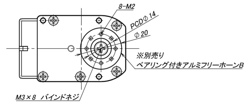
注) 別売りベアリング付きアルミフリーホーンを使用する場合 M3x8のネジを使用して下さい。それよりも長いネジやタッピングネジを使用するとケースや基板を破壊し故障の原因となります。
