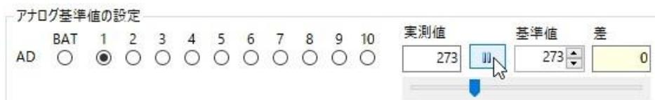
ロボットを前後方向に振ると AD2 が変化します。AD1 と同じように、AD2 も基準値の設定を行います。
