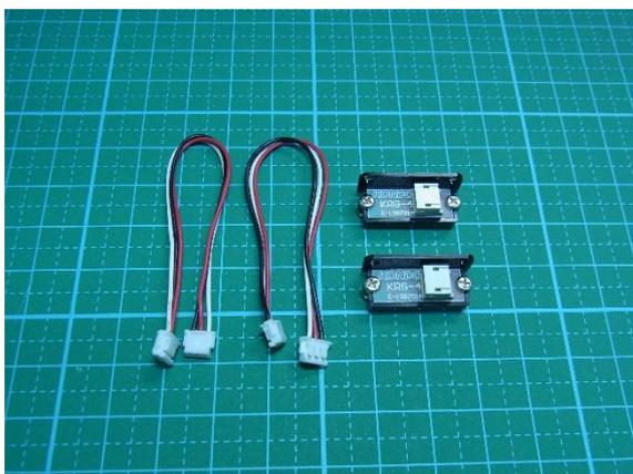
接続に必要なケーブルが付属していますので本セットのみご用意ください。ジャイロを固定するビスは、KXR の組み立てで余った M2-6 ビスを使用します。
