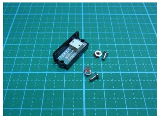
2. ビスを外したジャイロを搭載スペースに M2-6 ビスでビス止めします。ビスを外した穴をそのまま利用して固定してください。このジャイロは左右方向の角速度を検出します。
