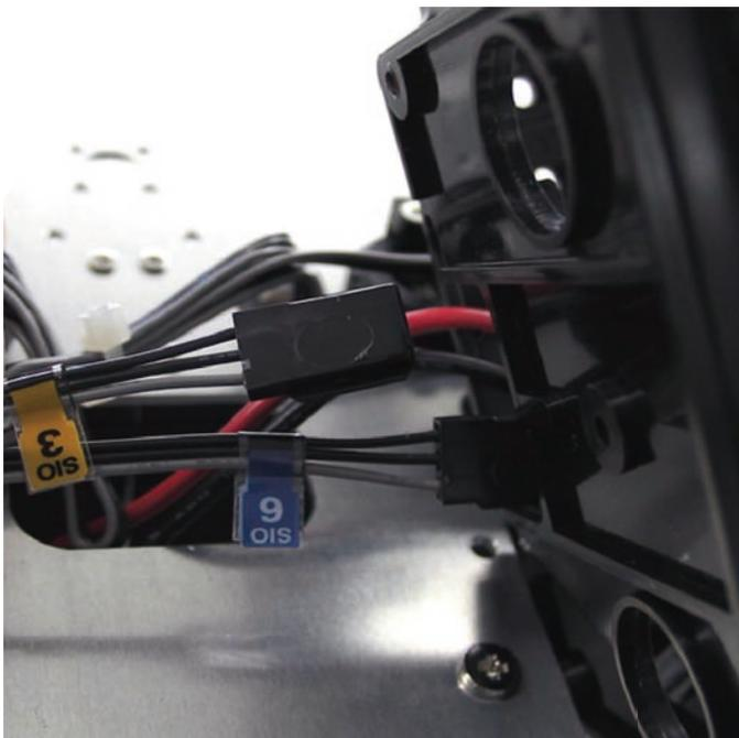
⑥ SIO3、SIO6 のデカルシールが付いたサーボケーブルを PCB ベース B の内側へ引き入れます。
