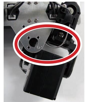
※後脚の部分は配線をアルミフレームとアームではさみやすいので、はさみ込まないように余裕を持たせて取り回すようにしてください。
