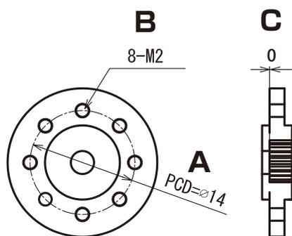
**A** (PCD=φ00)：フレーム取り付け穴のピッチ円直径 (mm)
